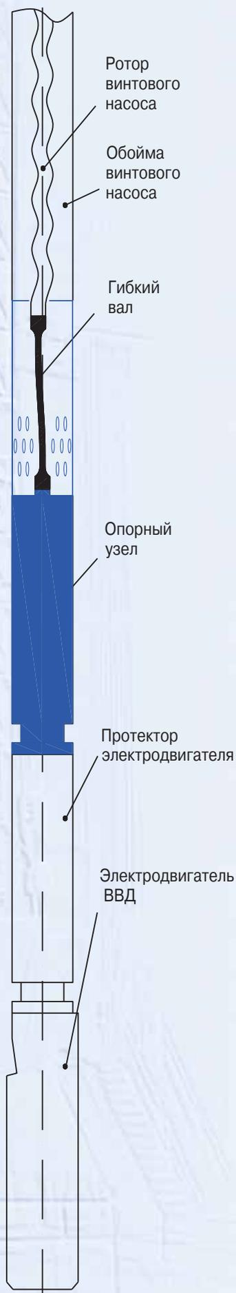
Вентильные электродвигатели типа ВВД работают в составе УЭВН с винтовыми насосами двух типов:
